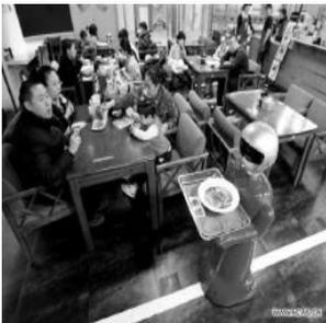
Ce robot rouge sert les clients dans un restaurant à Shenyang, au nord-est de la Chine. Il mesure 140 centimètres et peut porter une charge de 7 kg. Grâce à ses capteurs et son dispositif de navigation, il parvient à prendre les commandes, éviter les différents obstacles et surtout, apporter les aliments et les boissons sans les renverser. Autre atout pour ces robots, ils peuvent assurer 8 heures de service sans effectuer la moindre pause. En Chine,
