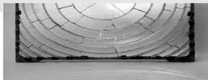
La première lentille à échelons de forme circulaire pour feux à éclats tournaient, créée par Augustin Fresnel et François Soleil en 1821. MnM ancien musée du service des phares. n° d'inventaire 19 PA 43D. © MnM/Arnaud Fux.
