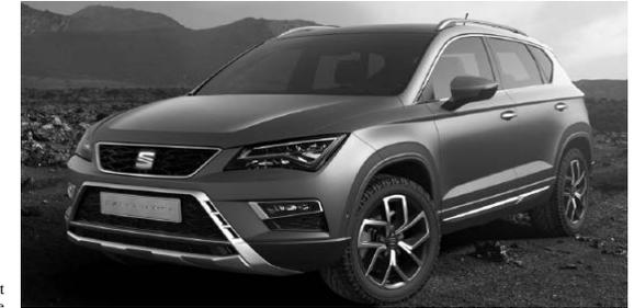
L'Ateca X-Perience est caractérisée par une garde au sol plus importante, un réglage de suspension ferme, des pneus all-road, des jantes exclusives 18 pouces, un moteur 2.0 TDI 190 ch, une boîte de vitesse automatique DSG 7 vitesses avec palettes. Un système de traction 4Drive avec un embrayage Haldex et le
