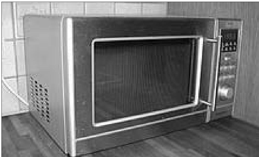
y avoir plus de charges électriques à certains endroits que d'autres, créant des arcs ou décharges électriques. Mais selon la forme, l'effet ne va pas être le même. Ainsi, l'impact d'une fourchette en métal plus pointue dans le micro-ondes va être plus important que celui d'une cuillère par
