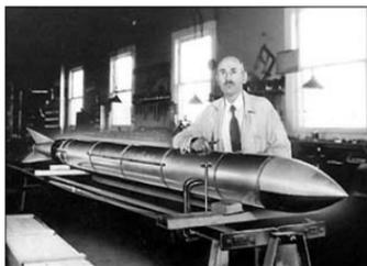
Le physicien américain Robert Hutchings Goddard réalise à Auburn dans le Massachusetts, le lancement d'une fusée propulsée par un mélange d'essence et d'oxygène liquide. L'engin atteint une altitude de 12,50 mètres et
