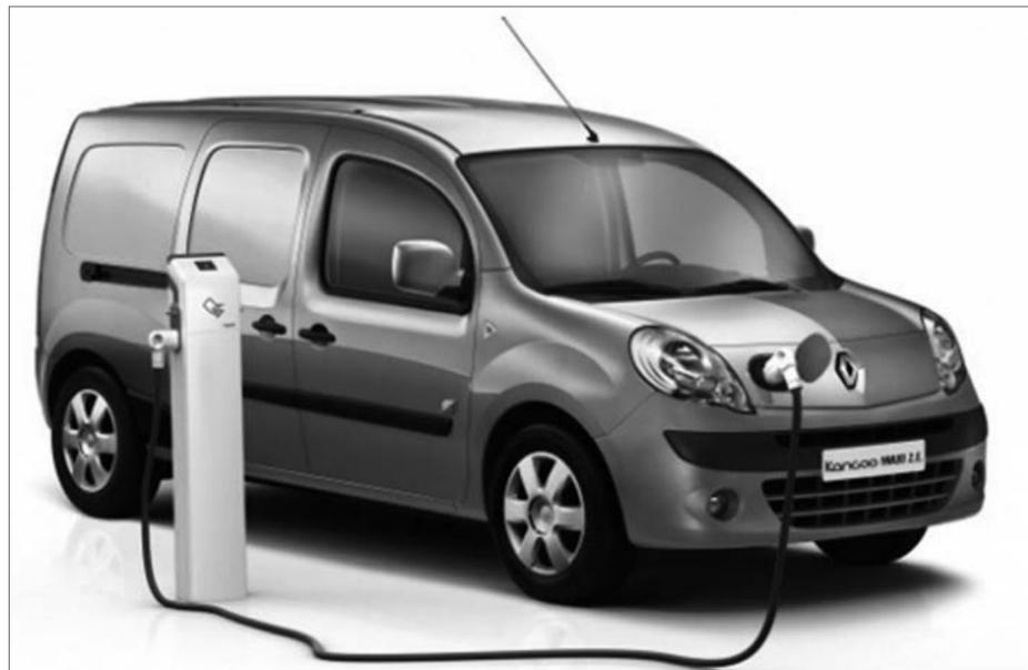
que de 44 km (60 ch) qui tracte cet utilitaire. Alimenté par une batterie Lithium-ion de 22 kWh placée sous le plancher, ce moteur offre une autonomie moyenne de 170 km en cycle mixte. Ce moteur dispose d'un couple maximum de 226 Nm disponible dès le démarrage.
