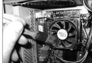
Passez une chaussette tout le long d'un fil de fer assez rigide. Faites des mouvements de haut en bas à l'intérieur du radiateur.
